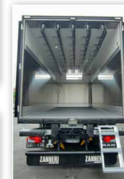
Rohrbahnen und Wände in Edelstahlverkleidung
