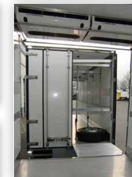
Einseitige Durchlademöglichkeit in den Anhängern, Doppelstockausführung
