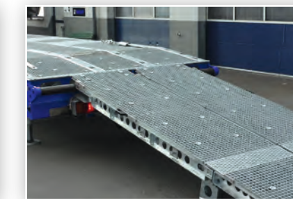
Hydraulisch verschiebbare, komplett zusammenfahrbare Rampenanlage
